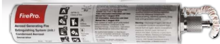
Extincteur aérosol pour une première intervention rapide et l'extinction des flammes Déclenchement thermique automatique, sans entretien
