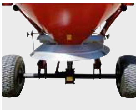
Limiteur d'épandage en acier inox
