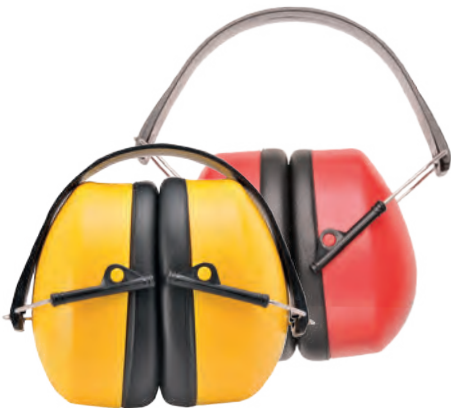
PW41 CASQUE ANTIBRUIT EN 352-1 SNR 30DB ANSI S3.19 NRR 25DB AS/NZS 1270 SLC(80) 31DB - CLASS 5
