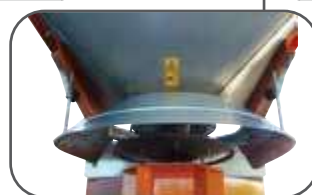
Disque et limiteur d'épandage en acier inox
