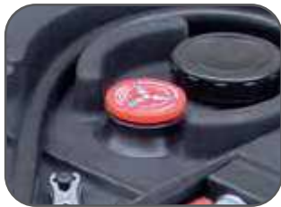
Soupape de surpression et d'aération
