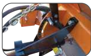
Accrochage, cardan et commande hydraulique d'ouverture de trappe trémie
