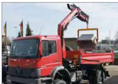
Basculé du bac à sel pour vider le contenu
