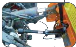
Accrochage, cardan et commande hydraulique d'ouverture de trappe trémie
