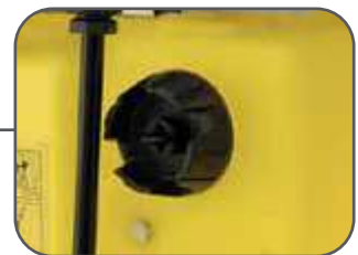
Bouchon de remplissage avec évent intégré
