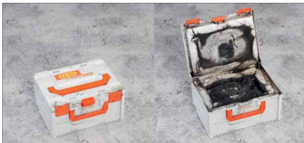
Test de résistance à l'emballement thermique d'une batterie Lithium
