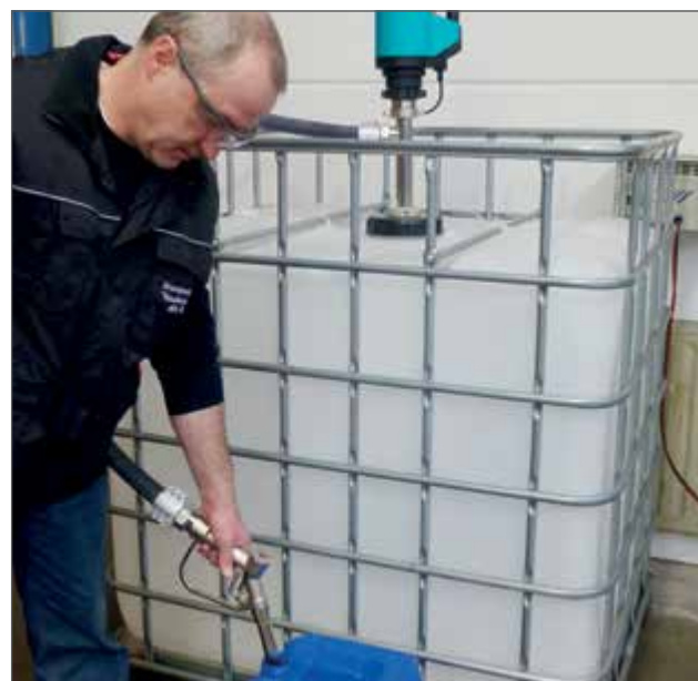
4 Pompe ATEX, pour solvants et liquides inflammables
