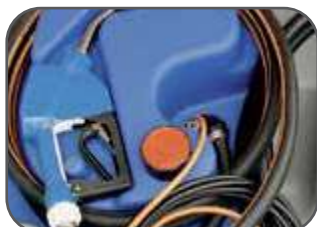
Réservoir additionnel d'AdBlue® avec support pistolet
